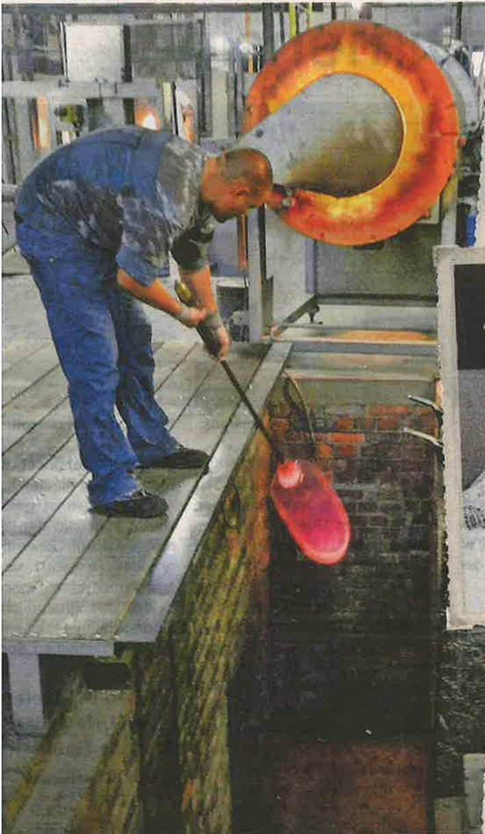
igte 2015 die harte Arbeit vom Glasblasen bis zur Fertigstellungswalze in der Schwenkgrube.
